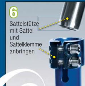
**Achtung:** Beide Seiten gleichmäßig anziehen. ABER NICHT ZU STARK! Sonst beschädigen Sie die Kugellager und das Laufrad kann sich nicht drehen. Es ist normal, dass die beiden Teile nicht aneinander stoßen.
